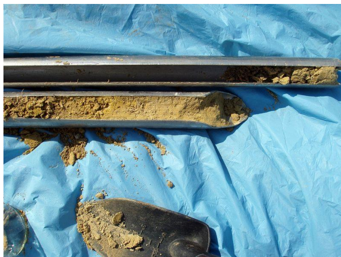
Obr. 8: Sprašové hlíny v profilu sondy ZS 2
